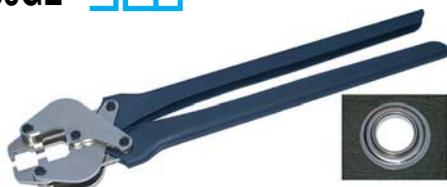
Tipo per occhielli giganti a grande capacità di pressione (1 Ton. circa). Modello brevettato, a doppia leva, per ridurre lo sforzo d'uso. Chiusura parallela delle ganasce con punzoni e matrici intercambiabili. Testa in acciaio temprato e impugnatura in robusta lamiera. Ideale per teloni, coperte, vele ecc. di forte spessore e robustezza.
